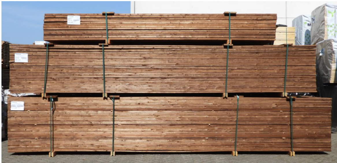
Abbildung 1 - Richtig gelagertes unbehandeltes Holz
