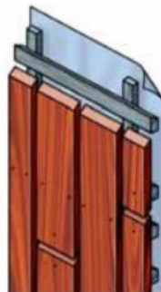
Abbildung 5 - Vertikale offene Fassadenverkleidung (Quelle: Centrum Hout, 2024)
